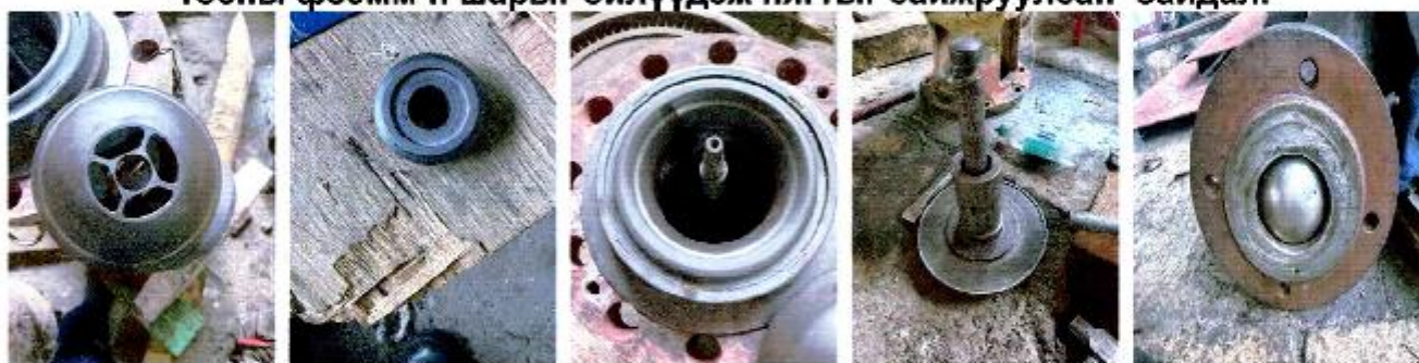
19. Турбины тос хөргөгч №1,2-ыг засварлаж зүрхэвчинд усан шахалт хийж будаж өнгө үзэмжийг сайжруулсан байдал.
